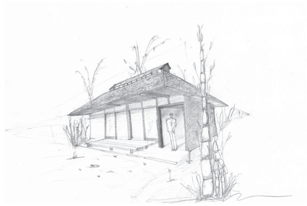
Figura 8. Esquema de una residencia tradicional japonesa que muestra un techo monitor. Basado en Wang et al. (2010). Dibujo de Antonio Castillo.
