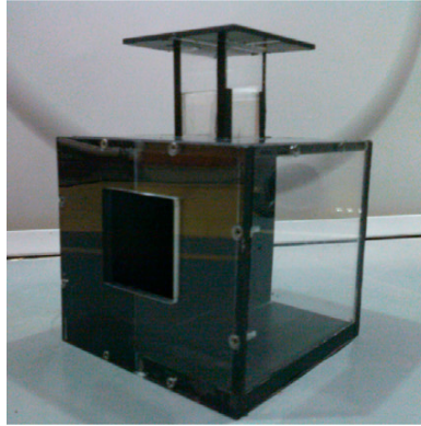
Figura 5: Modelo a escala 1/25 de una habitación con ventana y un intercambiador de viento instalado en el techo. Tomada de Cruz-Salas et al. (2014).
