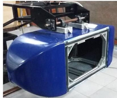
Figura 15 Nueva canastilla para la centrífuga del Laboratorio de Termociencias.
