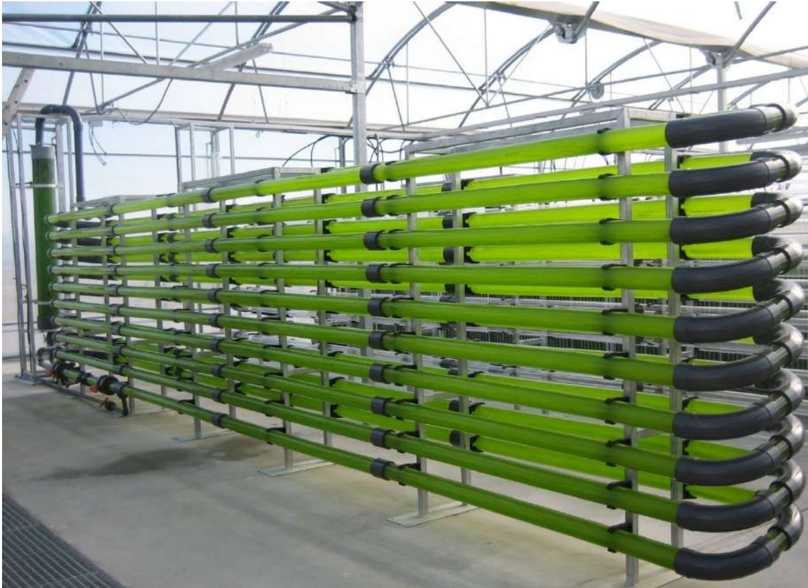
Foto 4 fotobiorreactor cerrado tubular horizontal fuente: algaenergy
