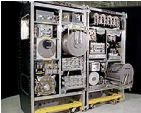
Foto 5 Sistema de Recuperación de Agua (WRS) Este sistema está alojado en 3 bastidores de Estacion espacial internacional. Fuente: NASA
